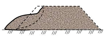
Причины оползания откосов насыпей завышенная крутизна откосов; недостаточная плотность грунта в зоне откосов; сооружение насыпи из слабых грунтов, непригодных для
